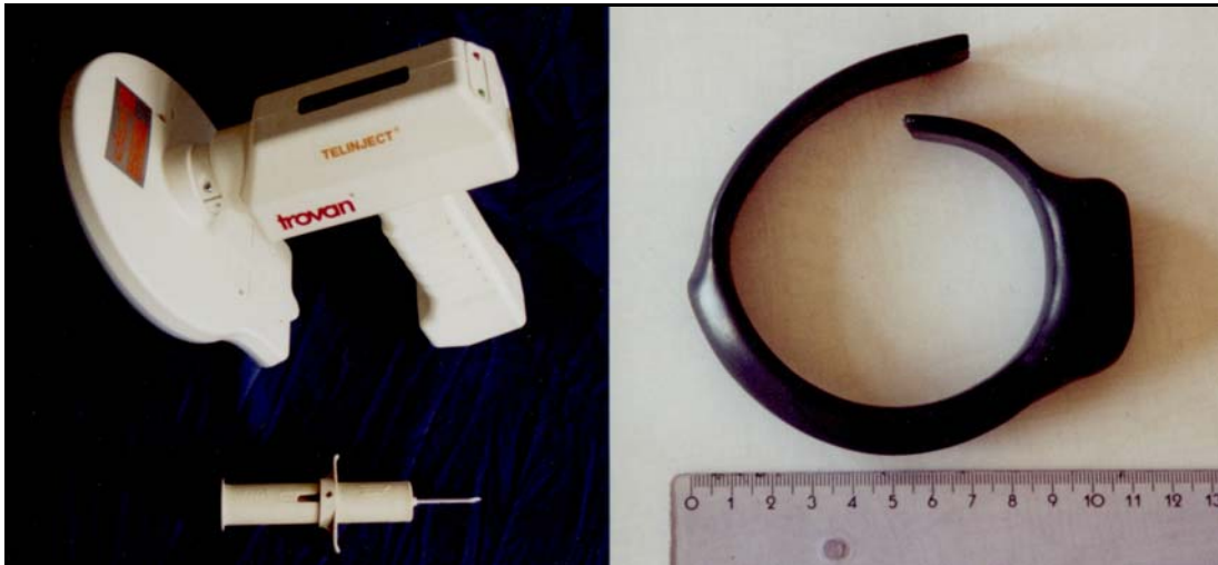
Abb. 10: Verwendetes Transponder-Lesegerät und Injektor (links), UKW-Waschbärsender mit Batterie/Sendereinheit und innenliegender Antenne. (Fotos F. Michler)
