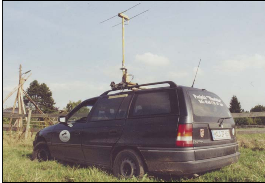
Abb. 11: Verwendete mobile Telemetrieanlage. Die Dachantenne ist über einen Drehgriff von innen um 360 ° zu drehen. (Foto F. Michler)
